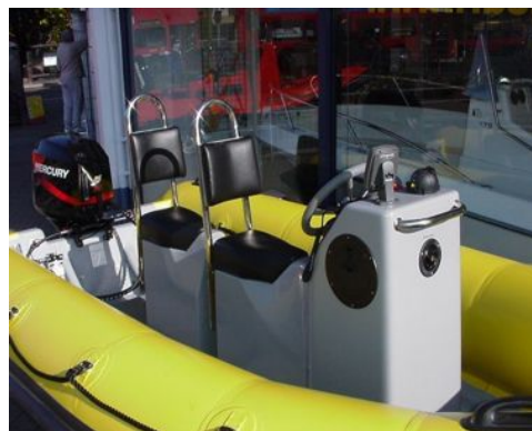
コンソール一体型ドライバーズシート & クルーシート アルミ製内臓燃料タンク (60L) と給油口
